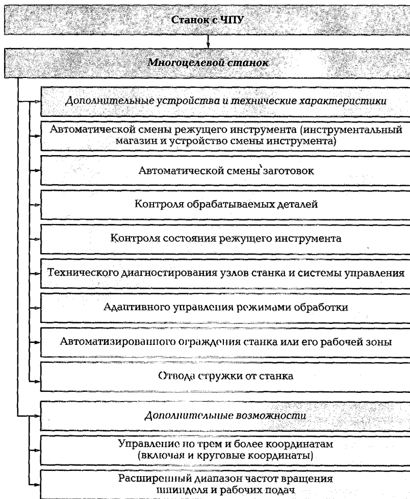
Рис. 2.13. Структурная схема многоцелевого станка
