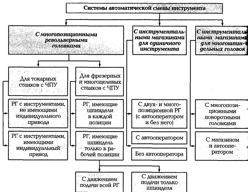
Рис. 4.6. Классификация систем автоматической смены инструмента
