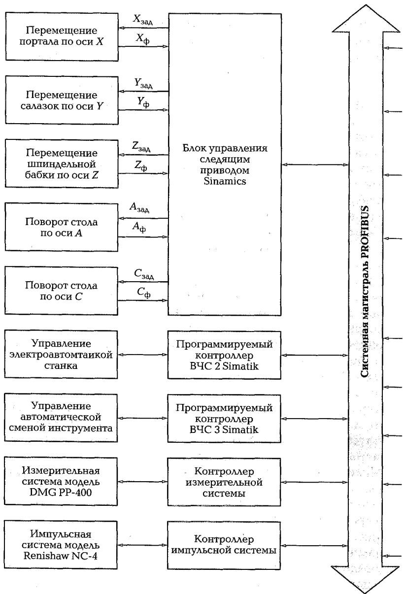
Рис. 3.5. Общая блок-схема устройства числового программного управления
